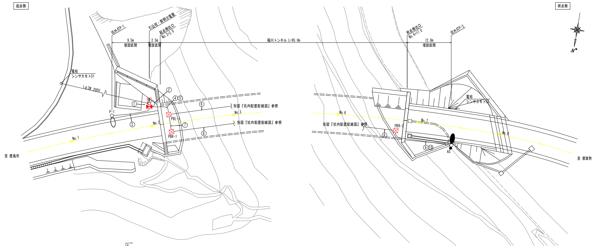
起点側坑口正面図 S=1:100 A-A
